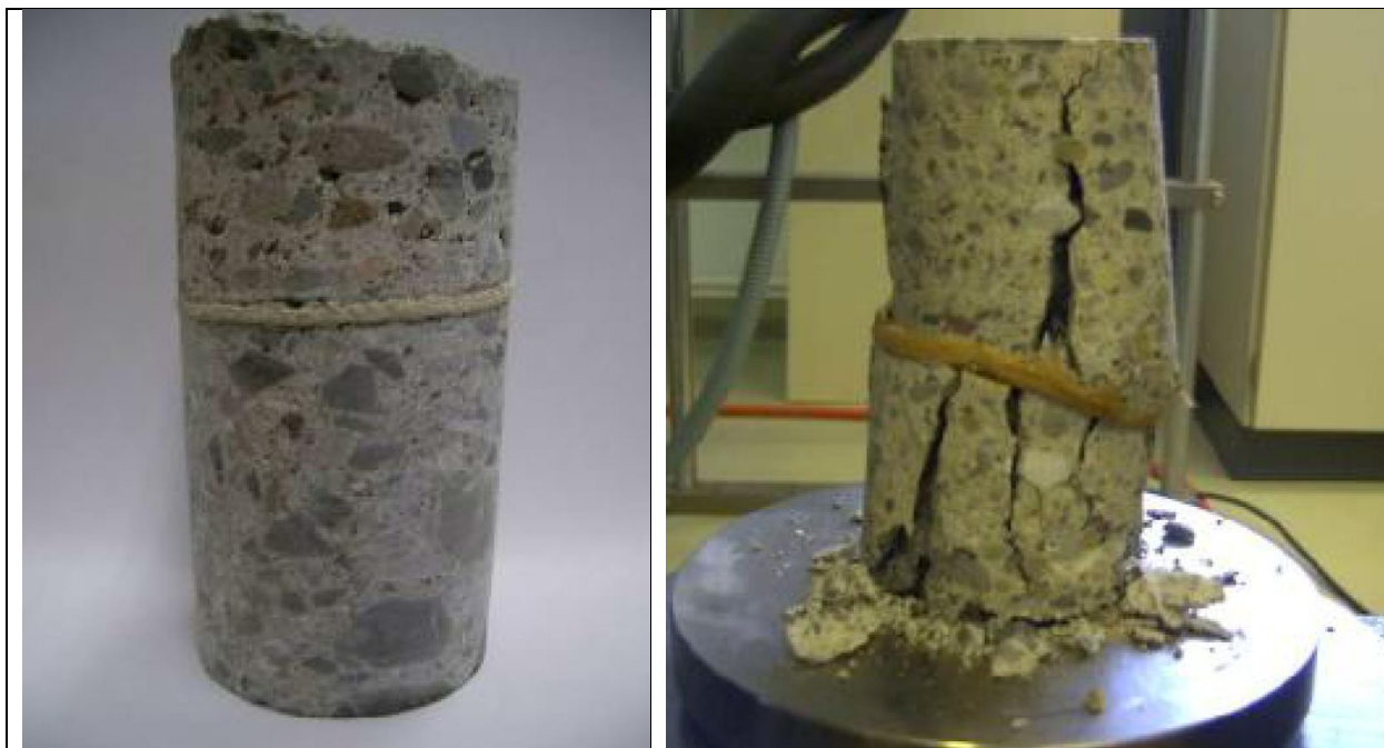
Obr. 15 Stříkaná hydroizolační membrána a její chování při zatížení
